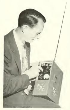
J. L. HATHAWAY HOLDS THE LATEST STREAMLINED MODEL OF THE PACK TRANSMITTER. BATTERIES TO OPERATE THE UNIT FOR 6 HOURS ARE INSIDE THE CABINET.
